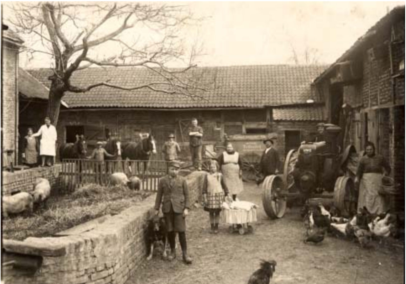
Bauernhof des Konrad Schauff in Köln-Junkersdorf, um 1930; rechts ein Großbulldog HR 2, wie er seit 1926 von der 1925 in Mannheim gegründeten Heinrich Lanz AG gebaut wurde
